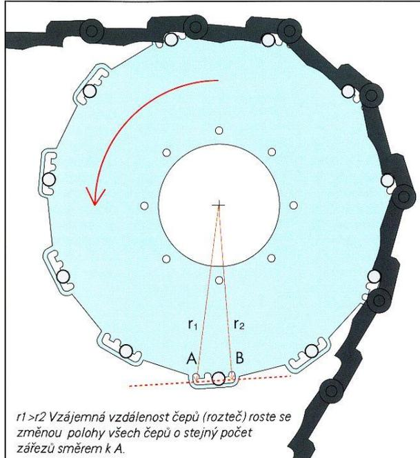
$r_1 > r_2$  Vzájemná vzdálenost čepů (rozteč) roste se změnou polohy všech čepů o stejný počet zářezů směrem k A.
