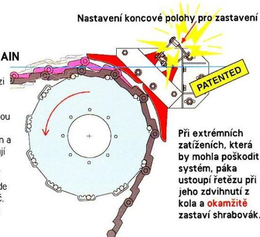
Při extrémních zatíženích, která by mohla poškodit systém, páka ustoupí řetězu při jeho zdvihnutí z kola a okamžitě zastaví škrabovák.
